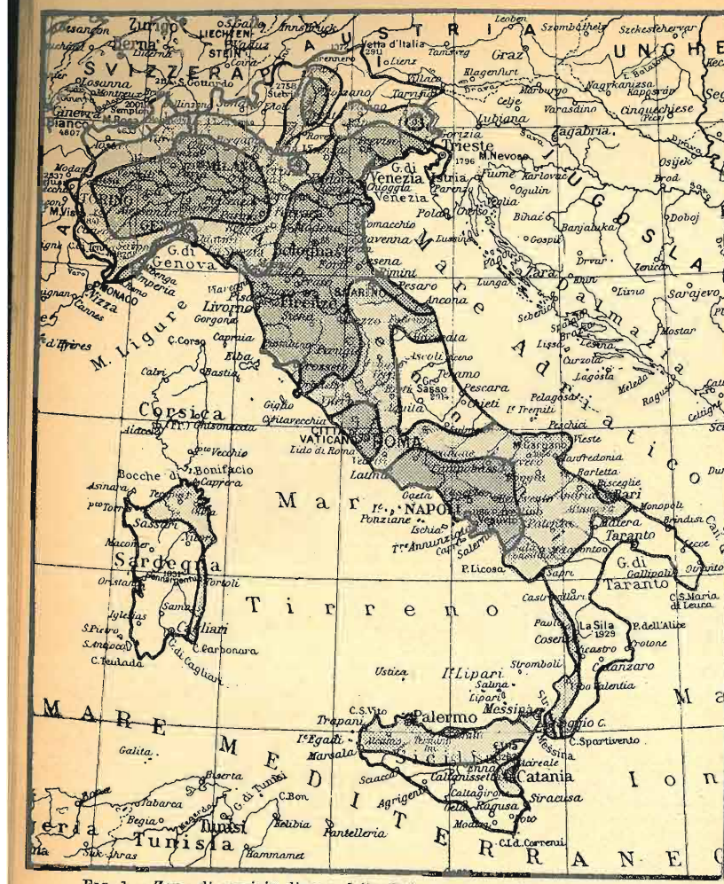
FIG. 1. - Zona di servizio diurna della Rete Azzurra (situazione attuale). Le zone più scure corrispondono ad un'intensità del campo superiore a 2,5 mV/m; quelle meno scure ad un campo superiore a 0,5 mV/m.
